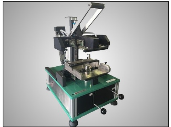
Dynamische Messung von Höhe und Durchmesser Plan- und Rundlauf von Zahnrädern
