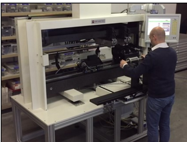
Horizontaler Messautomat, entwickelt um wellenförmige Werkstücke in der Serienfertigung zu messen. (Elektro-) Motoren und Achsen
