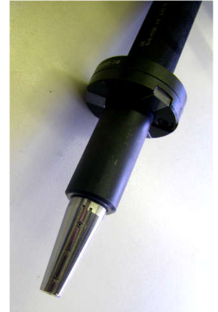
Kegelmessdorn in tiefer Bohrung
