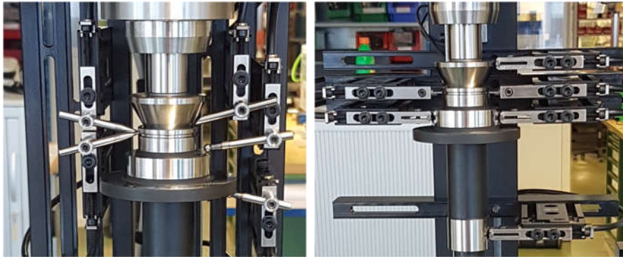
Der Monobloc Taster im Einsatz in Messvorrichtungen
